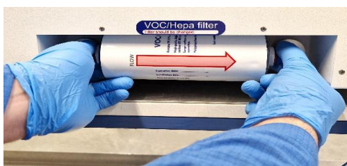
Slika 12.2 Postupak umetanja i uklanjanja VOC/HEPA filtra
